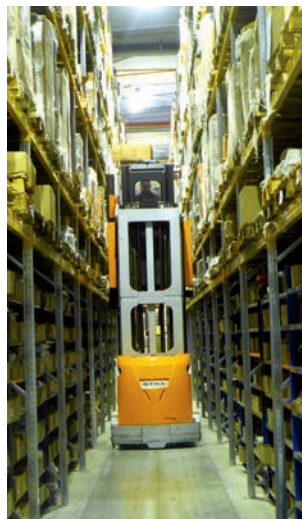
Chariot Still, automatisé par ADS pour la préparation de commandes
