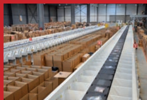
La trieuse affecte 12 000 pièces à l'heure à 320 destinations.
