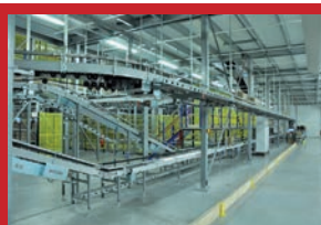
Le système de convoyage est directement relié au transtockeur, à partir duquel et vers lequel les colis sont acheminés.
