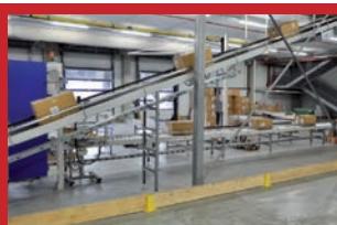
Les colis sont convoyés à partir des quais de réception. Flashés automatiquement, ils passent d'abord par un poste de travail afin d'être reconditionnés si nécessaire.
